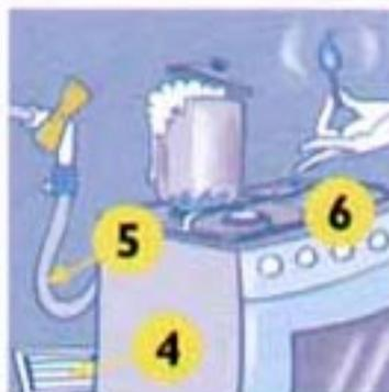
**5** Verificare la data di scadenza stampigliata sul **tubo flessibile** in gomma e sostituirlo se necessario (SCADE OGNI 5 ANNI).
